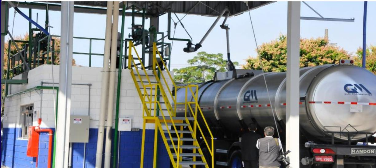
Verificação volumétrica de tanque de transporte de combustível líquido sobre caminhão-tanque.
