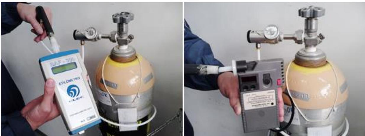
Na foto, etilômetros são verificados no laboratório de ensaios do Ipem-SP. A verificação metrológica é fundamental, pois dá suporte à ação da autoridade policial no controle do uso de bebidas alcoólicas pelos motoristas.
