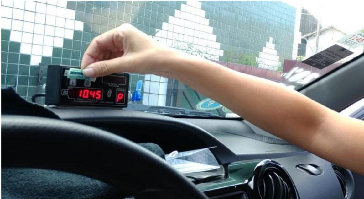
Na foto, fiscal do Ipem-SP aplica marca de verificação (selo do Inmetro) em taxímetro aprovado em verificação metrológica subsequente. Os ensaios para verificação dos erros de medição são feitos em pista demarcada, de modo a simular uma corrida.
