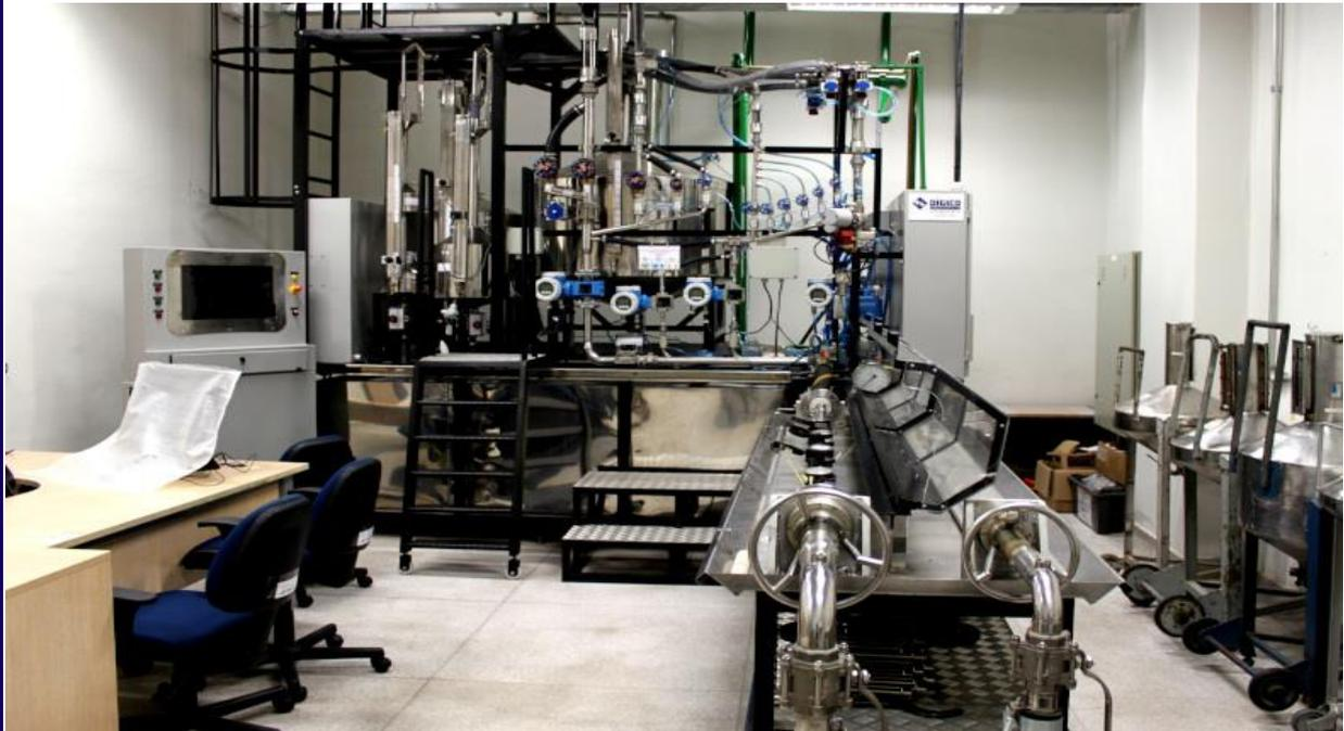
Acima: Bancada de ensaios em hidrômetros do laboratório de vazão
