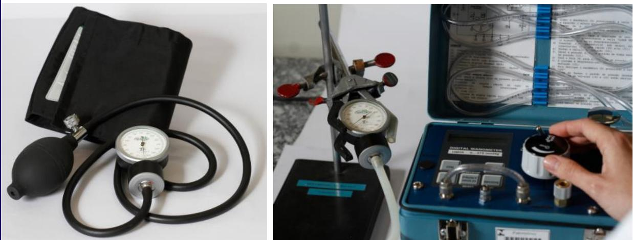
A verificação desses instrumentos é fundamental para um diagnóstico correto. Na foto da direita o esfigmomanômetro é verificado no laboratório de pressão do Ipem-SP.
