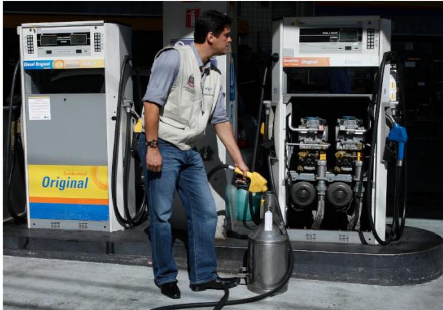
Acima, o fiscal do Ipem-SP procede aos ensaios de determinação de erros de medição em bomba medidora de combustível. Centenas de postos de combustível são fiscalizados diariamente, em todo o Estado.
