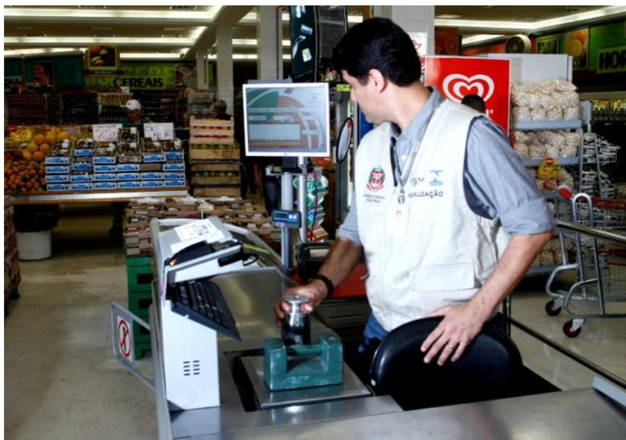
Na foto, Especialista em Metrologia e Qualidade (fiscal) do Ipem-SP procede aos ensaios de determinação de erros de medição em balança de “*check out*” de supermercado.
